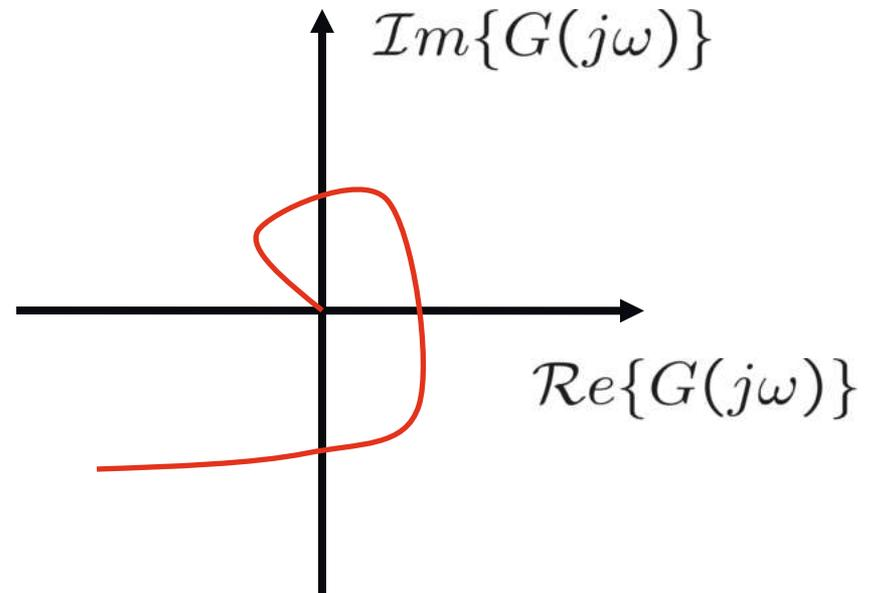
Come si tracciano le curve? Si possono calcolare per punti, una volta ricavata l'espressione di  $\mathcal{Re}\{G(j\omega)\}$  ,  $\mathcal{Im}\{G(j\omega)\}$  ; o sempre per punti conoscendo il diagramma di Bode di modulo e fase; oppure facendo uso ad esempio del sw Matlab...
